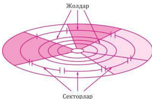
3.3-сурет. Магнит дискті форматтау кезінде жолдар мен секторларға бөлу
