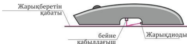
6.4-сурет. Оптикалық тінтуір әрекет ету принципі
