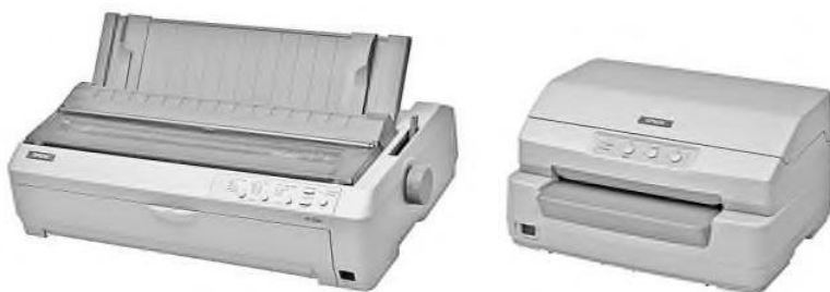
7.9. сурет. Матрицалық принтерлер
