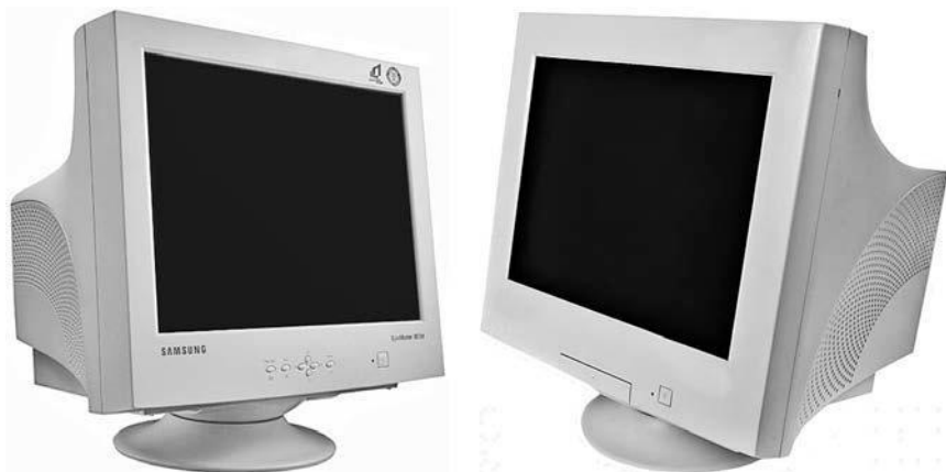
7.2-сурет. ЭСТ негізіндегі мониторлар
