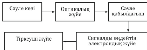
Сурет 12.21.Оптикалық-электрондық құрылғының жалпы құрылымдық схемасы
