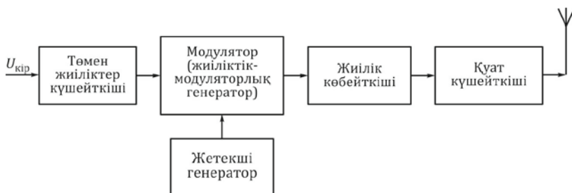
Сурет 10.3. Жиіліктік модуляциясы бар таратқыштық құрылымдық схемасы
