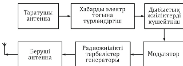
Сурет 10.1 Таратушы құрылғысының құрылымдық схемасы
