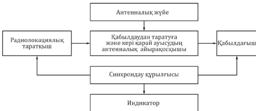
Сурет 12.1. Импульстік радиолокатордың оңайлатылған схемасы
