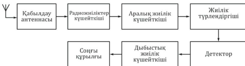
Сурет 11.1. Радиоқабылдау құрылғысының құрылымдық схемасы
