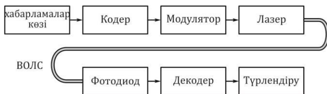
Сурет. 11.11. Талшықты-оптикалық байланыспен оптикалық байланыс желісі
