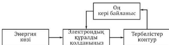
Сурет. 7.12. Автогенератордың блок-схемасы
