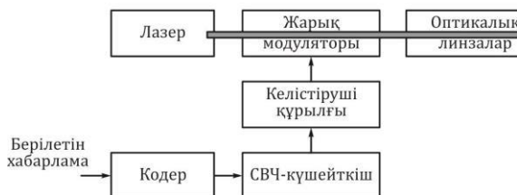
Сурет. 11.3. Оптикалық таратқыштың құрылымдық диаграммасы
