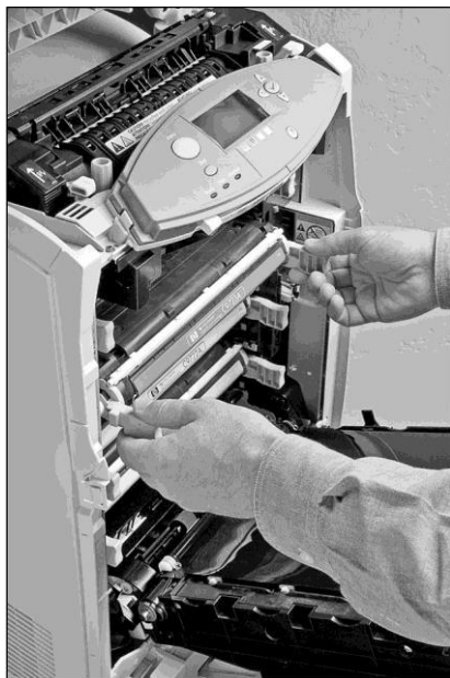
2.63-сурет. Принтерге тонер үшін картриджді орналастыру
