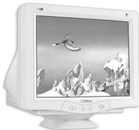
2.1.сур. Монитор на базе электронно-лучевой трубки
