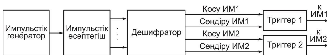
Сур. Т.4.1. Электрондық басқаруаппараты қатты локикасының құрылымы
