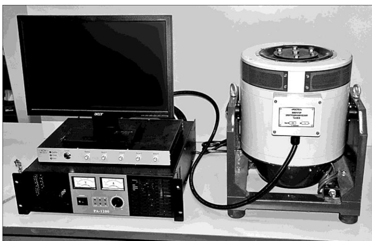
12.3-сурет. Үстел дірілдегіш қондырғының жалпы түрі
