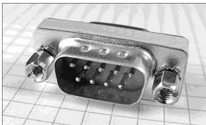
18.1-СУРЕТ. RS-232 типті жалғағыштың сыртқы түрі
