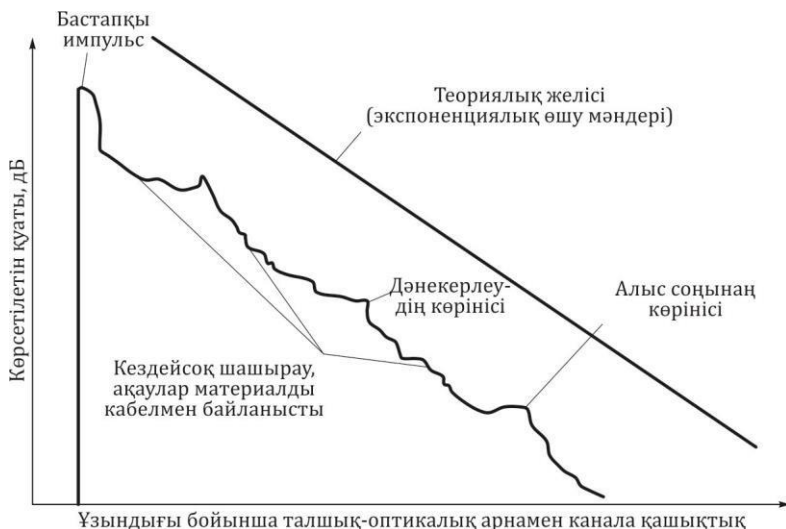
4.10. сурет рефлектометр қуаты талдаушы экранындағы қисық түрі
