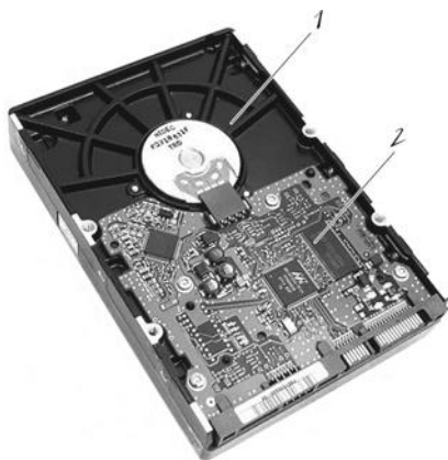
4.12 сурет. 3,5-дюймді қатты магнитті диск дисководы: 1 — магнитті диск орнатылатын ойық; 2 — баспа тақта
