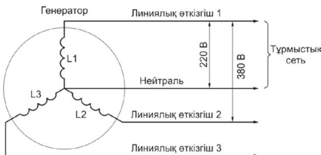
4.18 сурет. Ауыспалы токтың үш фазалы жүйесі: L1 , L2 , L3 — үш фазалы генератордың орамдары
