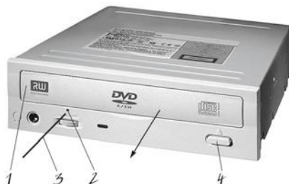
4.17 сур. Штаттан тыс жағдайлар кезінде дисководты ашу: 1 — дисковод лотогы; 2 — ойық; 3 — сым; 4 — лотокты ашу кнопкасы
