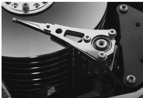
5.4 суреті Оқу/жазба бастиегінің тетігі. (Hubert Berberich көрсетілген, http://commons.wikimedia.org/wiki/File:Seagate-ST4702N-03.jpg .)
