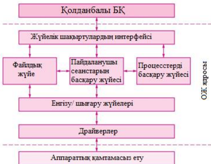
Сурет - 1.2. Қарапайым операциялық жүйе ядросының құрылымы
