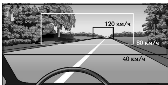
1.36 -суреті. Жылдамдықты арттыру кезінде тоннельдік әсердің пайда болу схемасы
