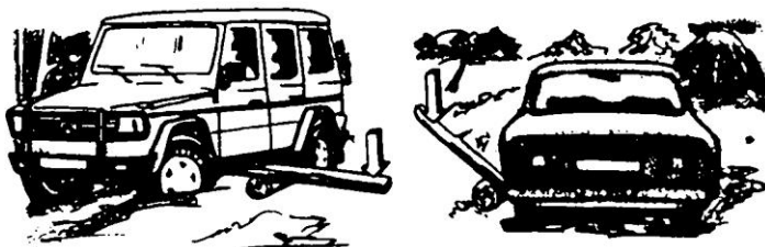
36-сур. Вага көмегімен автокөлік дөңгелектерін өлшеу
