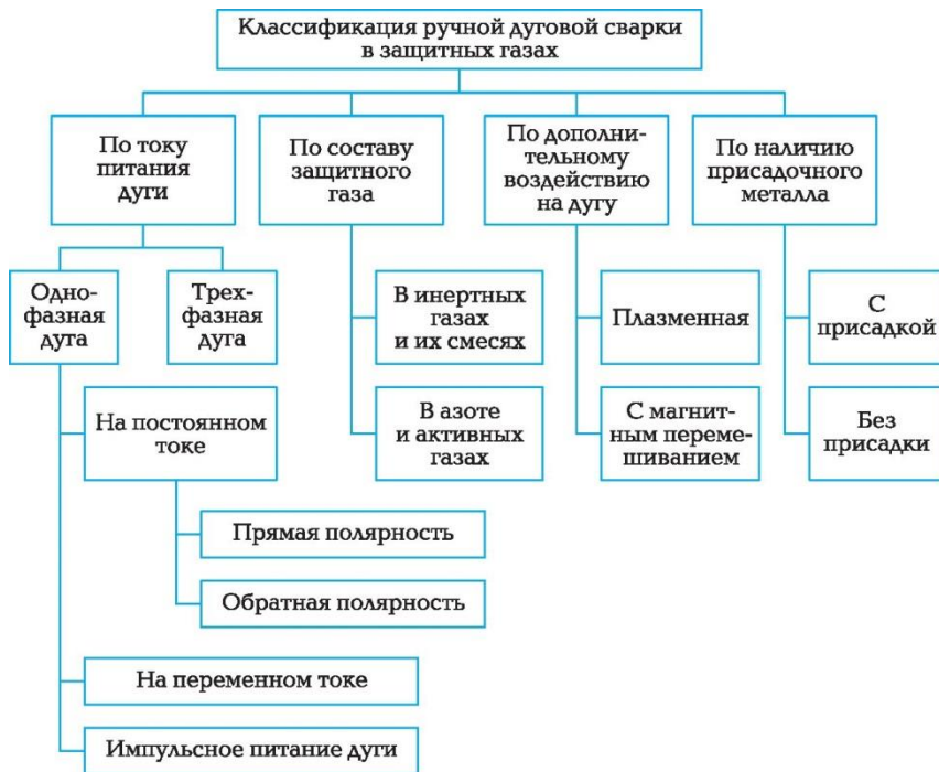
Сурет 2.15. Қорғауыш газдарда пісіру әдістерінің жіктелуі
