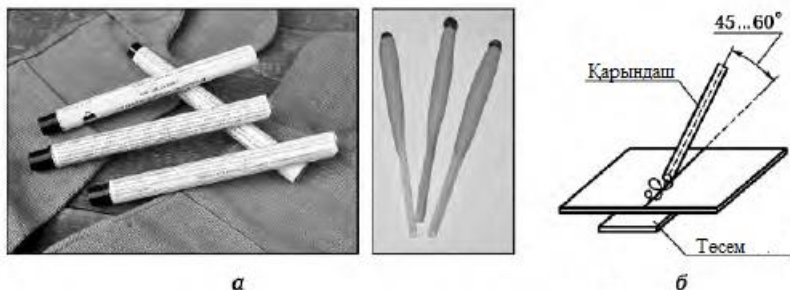
7.4-Сурет. (а) термосіріңкелі термитті қарындаш және (б) түйісті дәнекерлеу қосылысының сызбасы.
