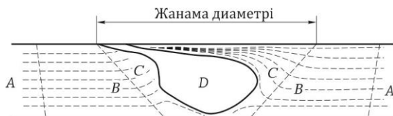
4.13-сурет. АҮД орындалған түйістік бірігудегі аумақтар сызбасы: А – негізгі металл; В – ТӨА; С – ТМӨА; Д – бірігу өзегі.
