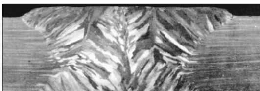
1.7-ші сурет. 30 мм дейінгі метал қалыңдығындағы электршлақтық дәнекерлеу барысындағы кристаллиттердің өсу бағыттары.
