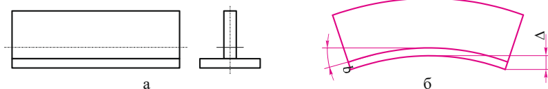
1.16 -шы сурет. Дәнекерлеу барысындағы таврлық арқалықтың деформациялануы: a – дәнекерлеуге дейінгі арқалық; б – дәнекерлеуден кейінгі арқалық; p – иілу бұрышы; D – иілу
