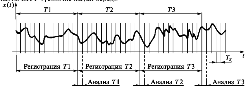
Рис. 7.15. Режим «жесткого» реального времени
