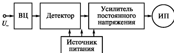
Сур. 3.20. Айнымалы кернеу электрондық вольтметрлерінің құрылымдары: a — күшейткіш—детектор — аспап; б — детектор — күшейткіш — аспап
