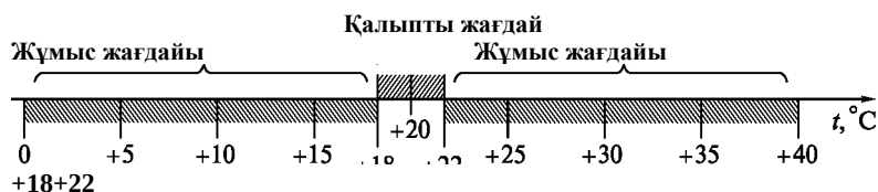
1.12 сурет. Әсер етуші шаманың – қоршаған ортаның температурасының мүмкін болатын мәндерінің диапазоны
